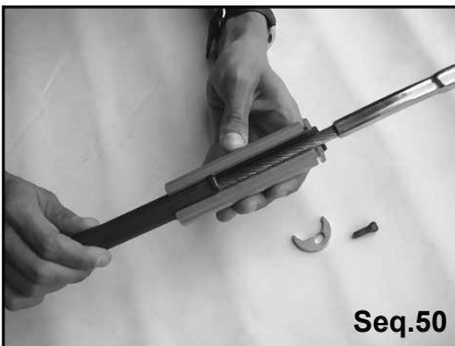
Glisser le 2ème demi palier dans l'éclisse. Slide the 2nd 1/2 bearing into the bearing holder.
